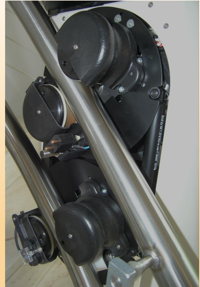
Nahaufnahme der Antriebsrollen des Traktionsantriebs
